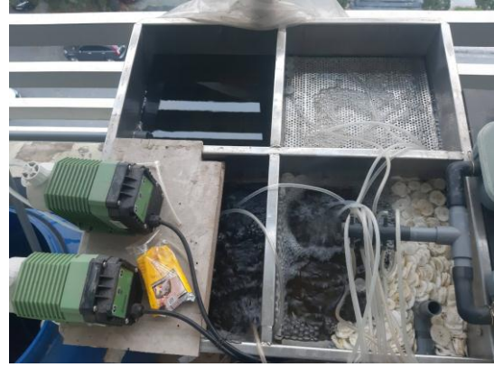
Hình 2.7: Mô hình xử lý nước thải sinh hoạt theo công nghệ MBBR công suất 2 – 10 lít/giờ.
