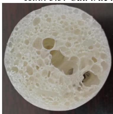
Hình 3.3: Cấu trúc xốp của mẫu sử dụng nhựa MFI=10.
