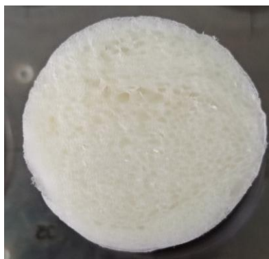
Hình 3.2: Cấu trúc xốp của mẫu sử dụng nhựa MFI=5.
