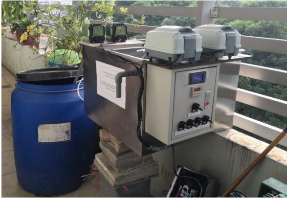
Hình 2.7: Mô hình xử lý nước thải sinh hoạt theo công nghệ MBBR công suất 2 – 10 lít/giờ.
