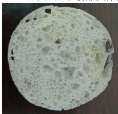
Hình 3.2: Cấu trúc xốp của mẫu sử dụng nhựa MFI=5.
