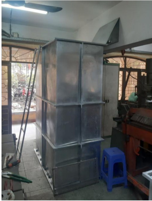
Hình 3.40: Chế tạo mô hình xử lý nước thải tại công ty DRET
