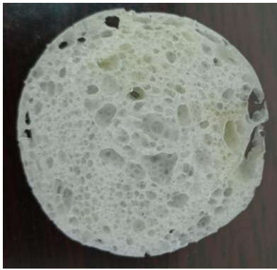
Hình 3.3: Cấu trúc xốp của mẫu sử dụng nhựa MFI=10.
