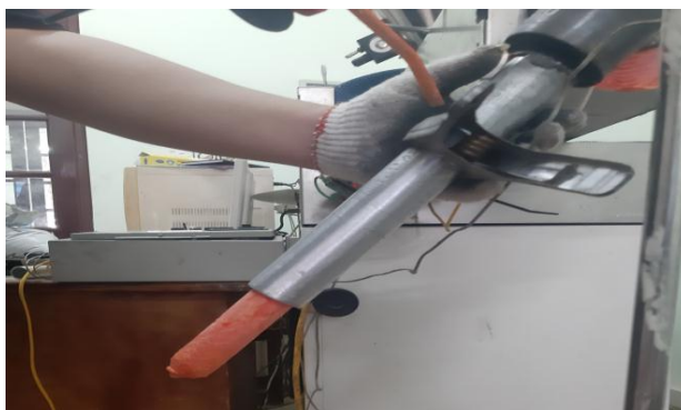
Hình 3.21: Máy đùn và khuôn đùn tạo xốp PE.
