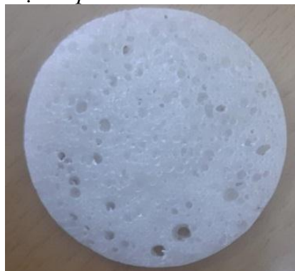
Hình 2.3: Sản phẩm sau khi ra khỏi khuôn đùn và sau khi được cắt.
