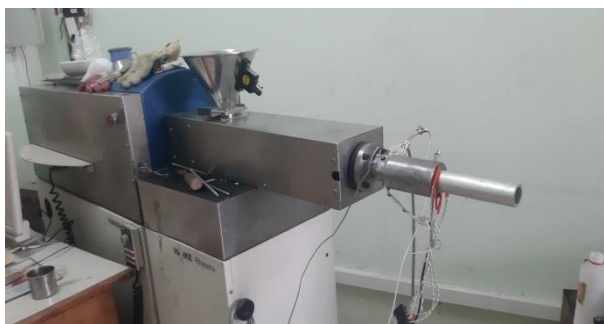
Hình 2.2: Máy đùn và khuôn đùn tạo xốp PE.
