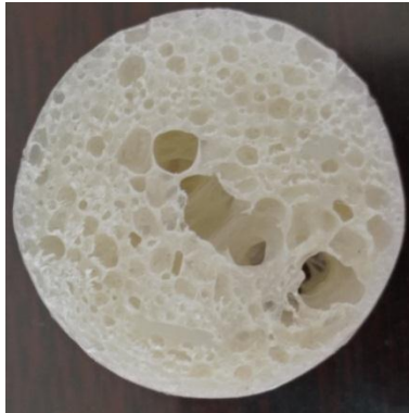
Hình 3.4: Cấu trúc xốp của mẫu sử dụng nhựa MFI=20.
