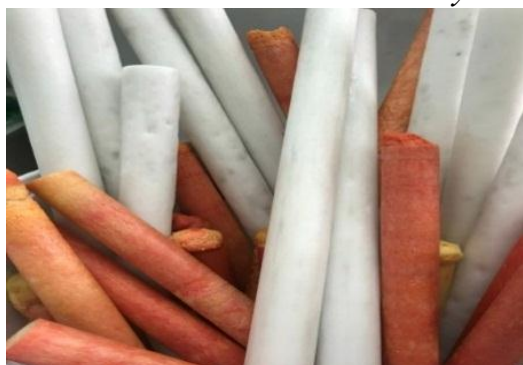
Hình 3.22: Sản phẩm ống xốp giá thể sau khi đùn
