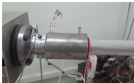
Hình 2.2: Máy đùn và khuôn đùn tạo xốp PE.
