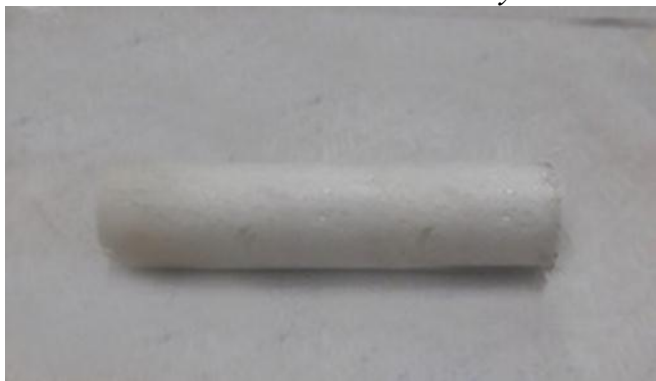
Hình 2.3: Sản phẩm sau khi ra khỏi khuôn đùn và sau khi được cắt.
