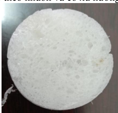
Hình 3.1: Cấu trúc xốp của mẫu sử dụng nhựa MFI=1.
