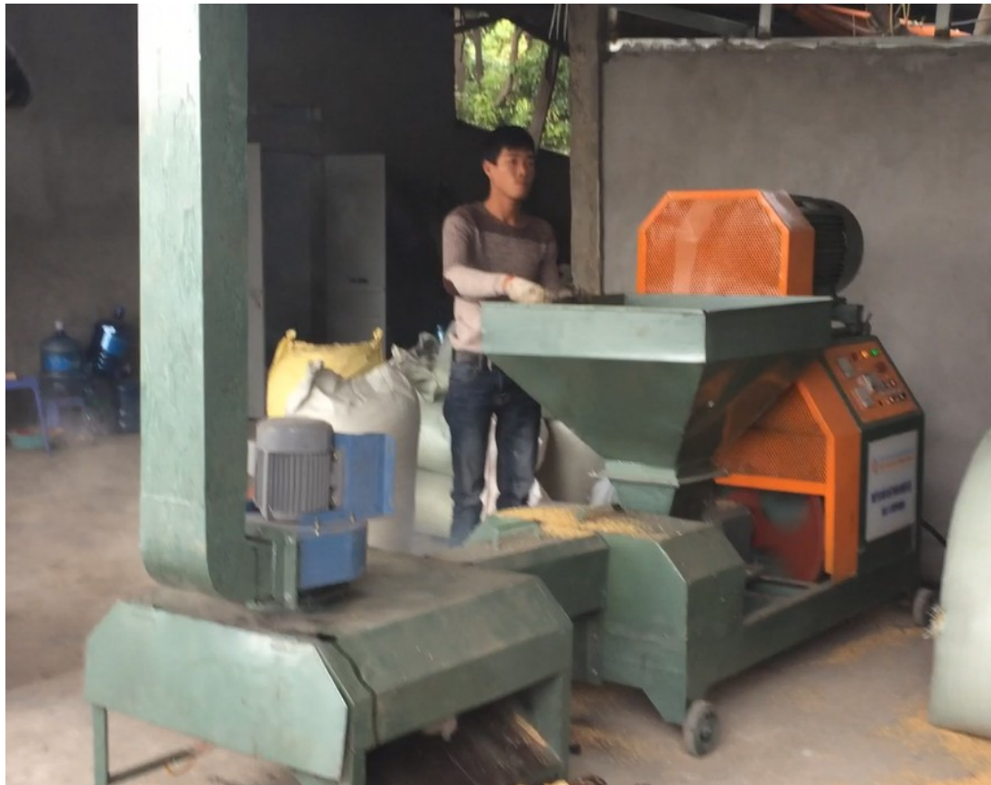
Hình IV-33: Thiết bị sản xuất thanh nhiên liệu IES.17/BSM200 lắp đặt tại cơ sở sản xuất
