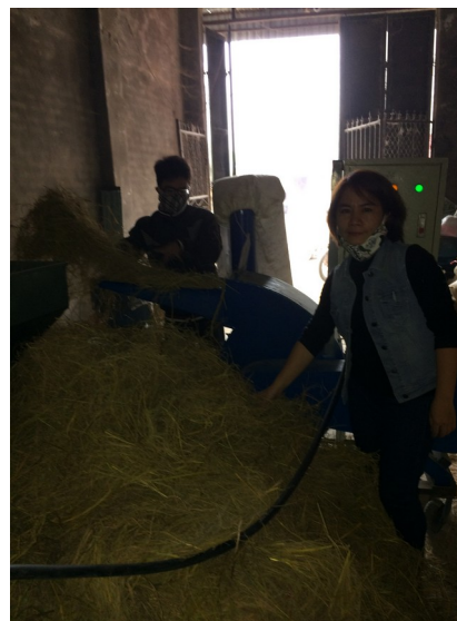
Hình V-38: Rơm - rạ sau khi nghiền có kích thước <math><20\text{[mm]}</math>
