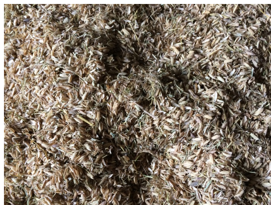
Hình V-38: Rơm - rạ sau khi nghiền có kích thước <math><20\text{[mm]}</math>
